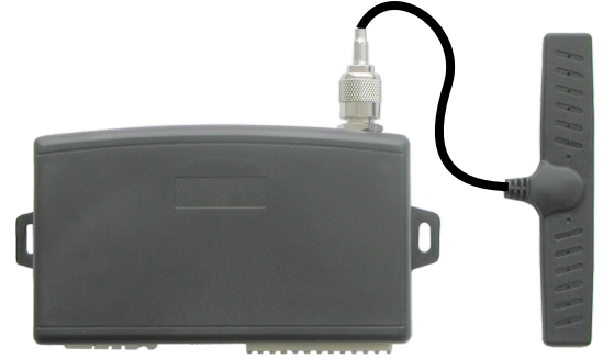
1 pav. Sergėjimo sistemos GSM komunikatorius GSW1U.
